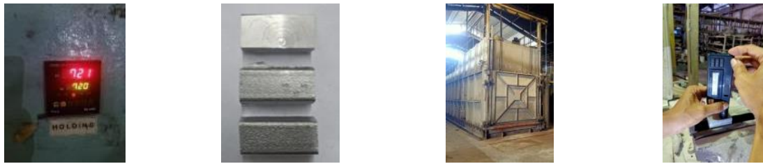
(a) Peleburan logam cair (b) Sampel uji (c) Oven perlakuan panas (d) Alat uji PHT11300
