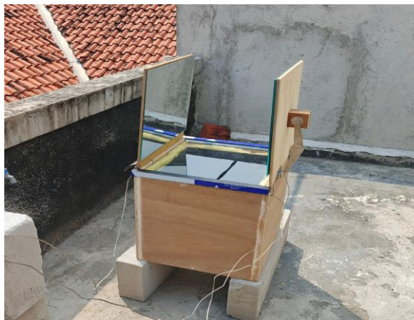
Gambar 1. Kompor surya tipe kotak
