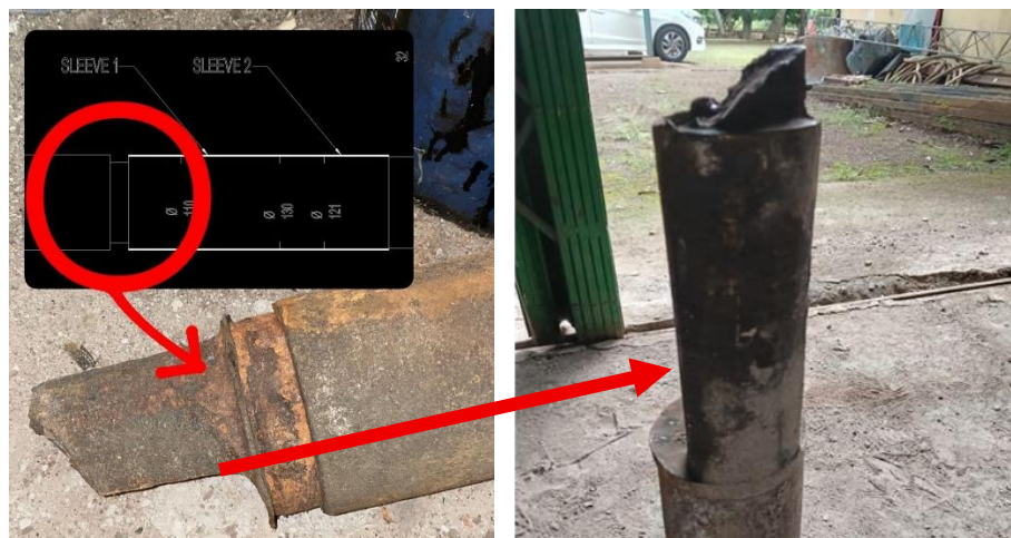
Gambar 3. Terjadi Pengecilan Ukuran Pada Poros dari Desain yang Seharusnya
