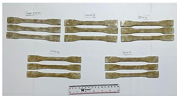
Gambar 4. Spesimen uji tarik hybrid-komposit epoxy resin/fiberglass dan serat bambu petung
