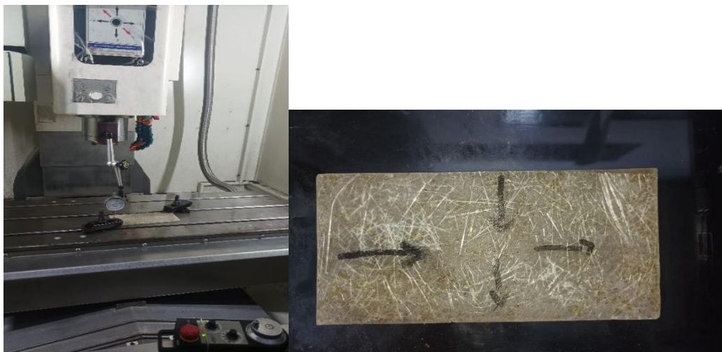
Gambar 11. Pengujian kerataan permukaan menggunakan alat ukur dial indikator
