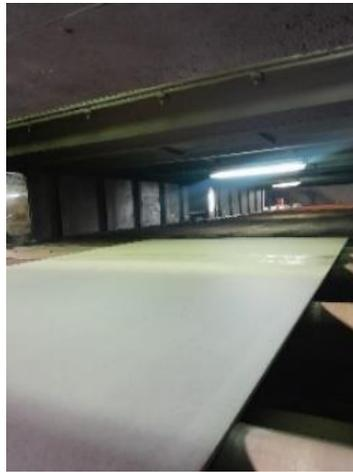
**Gambar 1.** Pelat Baja *Grade A* Ketebalan 10 mm
