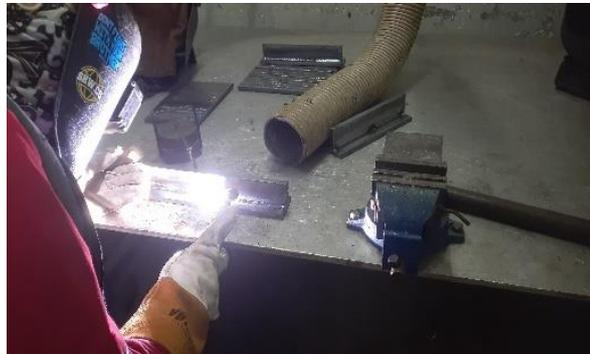
**Gambar 3.** Proses Pengelasan GTAW pada Material Pelat Baja *Grade A* dan Elektroda ER70S-G
