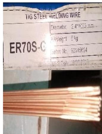
**Gambar 2.** Elektroda ER70S-G
