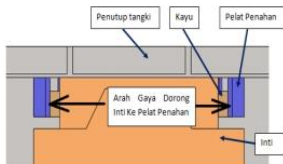
Gambar 5. Gaya dorong inti transformator ke pelat penahan.
