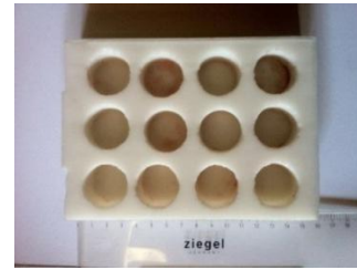
Gambar 1. Cetakan spesimen komposit kampas rem Campuran yang telah dmasukkan dalam cetakan dibiarkan 24 jam sampai mengeras sempurna, dan dikeluarkan dari cetakan seperti pada Gambar 2.
