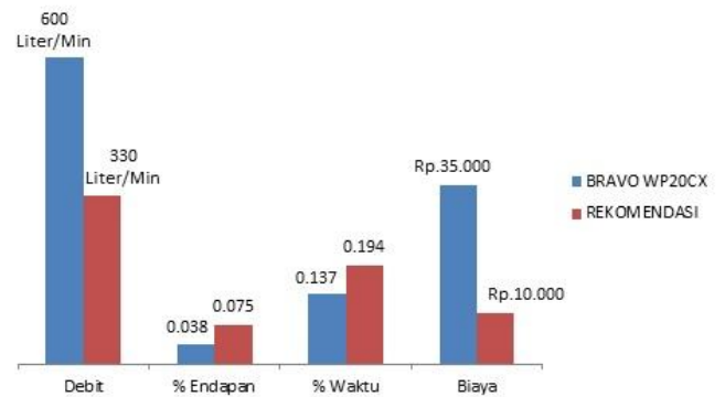
Gambar 11. Perbandingan Pompa aktual dan rekomendasi
