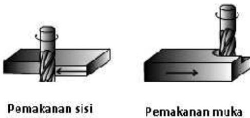
Gambar 2. Pemotongan pisau frais.
