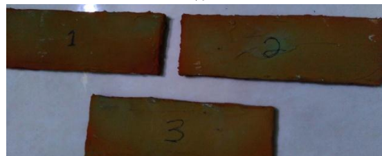
Gambar 7. Uji korosi spesimen dengan kadar garam 2%
