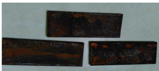
Gambar 12. Uji korosi spesimen dengan kadar garam 3%
