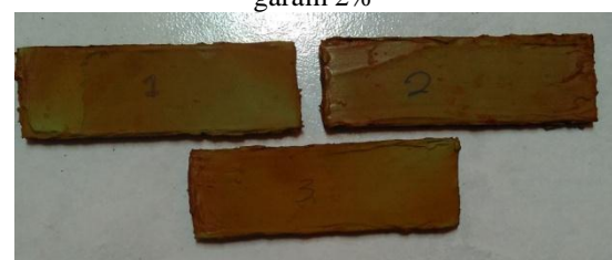
Gambar 8. Uji korosi spesimen dengan kadar garam 3%
