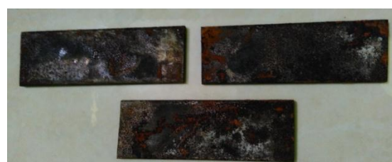
Gambar 10. Uji korosi spesimen dengan kadar garam 1%
