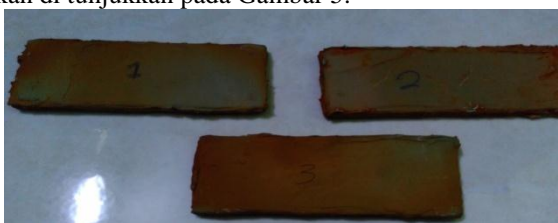
Gambar 5. Uji korosi spesimen dengan kadar garam 0,08%.
