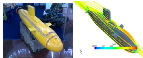
Gambar 1. Design Kapal selam mini 22 meter karya Kol (Purn) Ir. Drajat Budiyo MBA (2006) dan simulasi numerik
