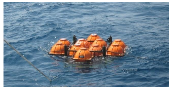
Gambar 6. OBU saat mengapung di permukaan laut setelah beroperasi di dasar laut[2]
