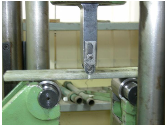
Gambar 10. Proses uji tekuk spesimen fiberglass [2]
