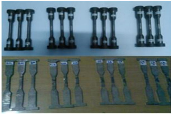
Gambar 3. Bentuk Speciment Penampang Bulat dan Kotak
