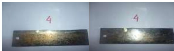
Gambar 3 Uji Korosi Specimen dengan khrom 10 menit
