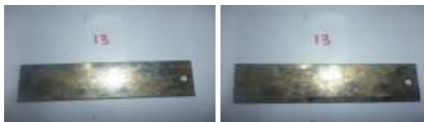
Gambar 6. Uji Korosi Specimen dengan khrom 25 menit
