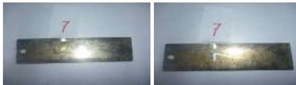
Gambar 4. Uji Korosi Specimen dengan khrom 15 menit
