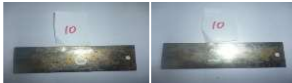
Gambar 5. Uji Korosi Specimen dengan khrom 20 menit
