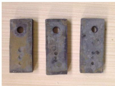
Gambar 6. Hasil uji korosi pada baja
