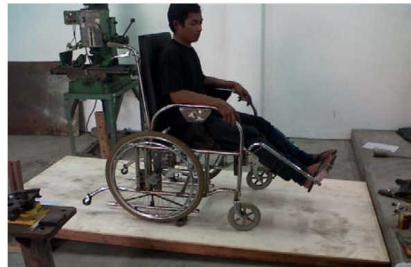
Gambar 9. Pengujian kursi roda jalan bidang menurun
