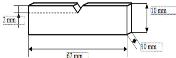
Gambar 4 Spesimen uji *impact* sesuai ASTM D265
