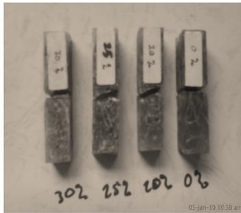
Gambar 8 Bentuk patahan setelah diuji Impact
